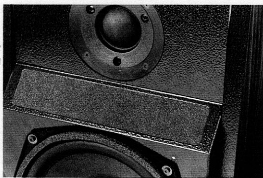
スピーカーの下部には反射による影響を抑えるため スポンジが貼られている
