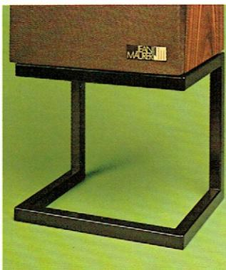
Tous les corps creux de ce socle en tube d'acier thermolaqué sont remplis de sable de quartz. Livré avec 2 pointes inox, il permet d'absorber encore les faibles résidus de vibrations de l'enceinte. En option pour JM 220 D et JM 320 D.
