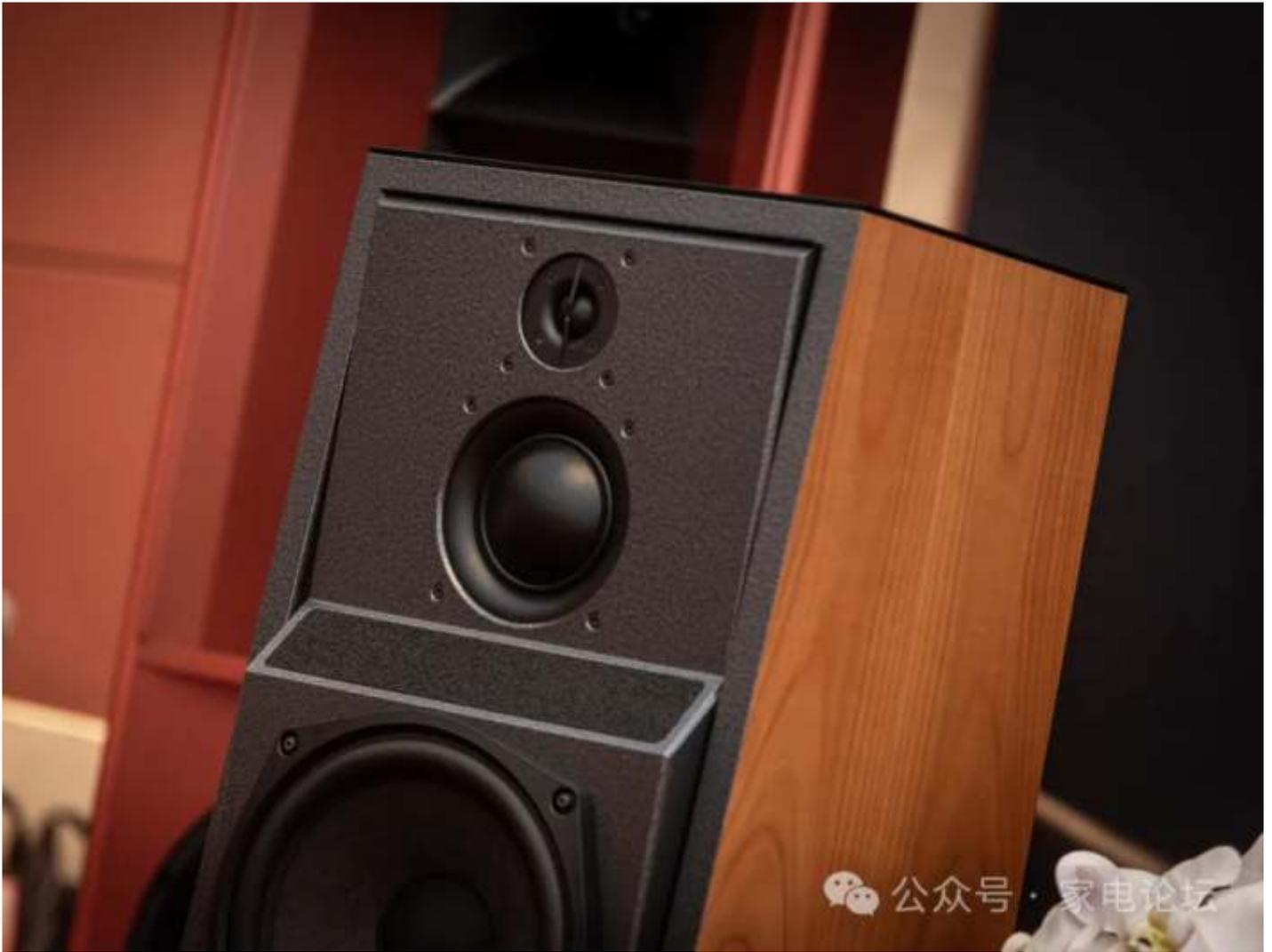
**Système à trois voies :** la JM 370F est dotée d'un système à trois voies avec des haut-parleurs séparés dédiés aux basses, moyennes et hautes fréquences. Cette conception permet une reproduction plus précise du son sur l'ensemble du spectre de fréquences, ce qui se traduit par des performances sonores supérieures.
